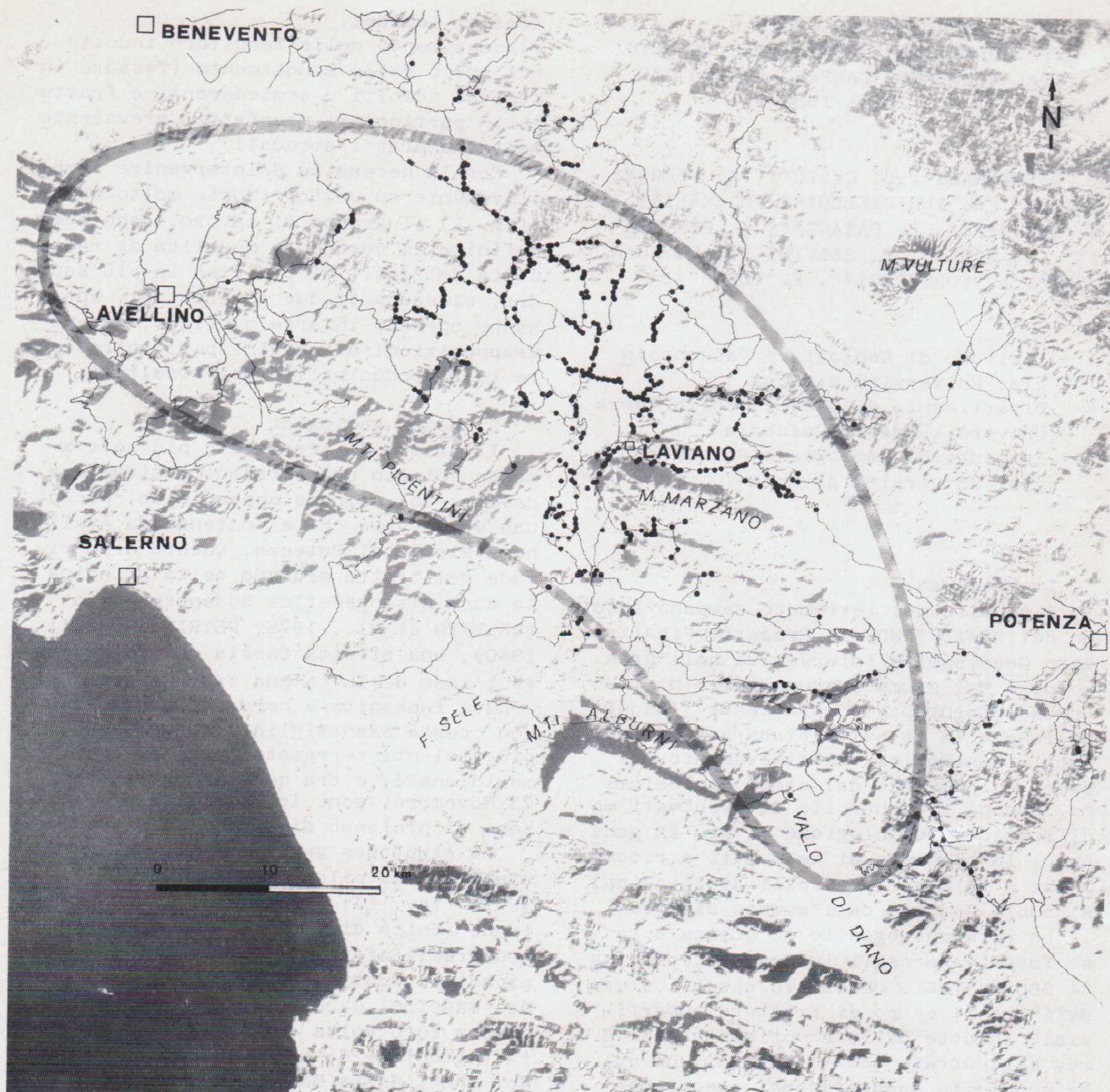
Fig. 1 - Immagine da satellite LANDSAT dell'area colpita dal sisma del 23/11/1981. Nella figura sono riportate le stazioni di misura (punti neri), il reticolo delle strade percorse (linee nere) e l'isosista di grado VIII° (linea grigia).
