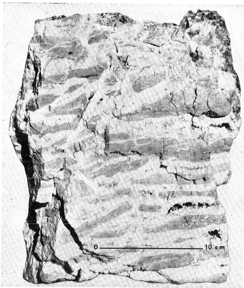
Fig. 20 — Pseudobreccia derivata dalla anastomosi di fratture riempite da dolomite. Campione raccolto lungo la strada Pignola-Abriola al Km. 11.
