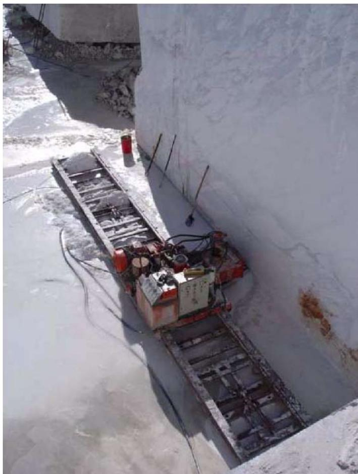
**Figura 3** Tagliatrice a catena posizionata per il taglio orizzontale delle bancate.
