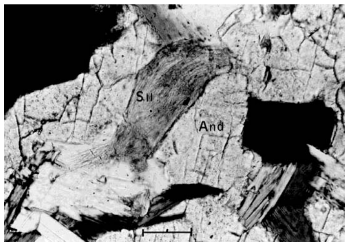
Fig. 29 – Inclusi di sillimanite (Sil) in porfiroblasti di andalusite (And) in micascisto in facies anfibolitica con sovraimpronta di HT-LP (Asinara settentrionale) (nicol incrociati, scala di riferimento: 1 mm).
